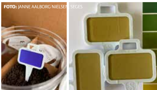
FOTO: JANNE AALBORG NIELSEN, SEGES Til venstre ses testproben fra Solvita®, når testen starter. Til højre ses farveskift på testproberne efter 24 timer.
